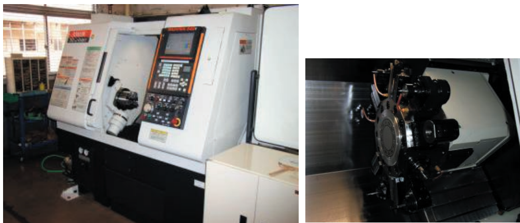
図 1 CNC 旋盤 (Mazak 100MY) 本体とツールホルダ (一部ミーリング工具)
