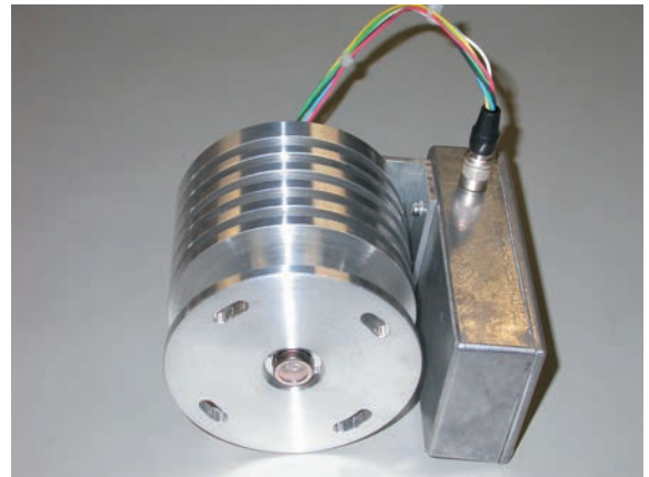
電子冷却型 PbS 光導電素子駆動回路 PbS センサ :P2682( 浜松ホトニクス ) 冷却温度 : -20^{\circ}\text{C} 温度安定度 : \pm 0.2^{\circ}\text{C}
