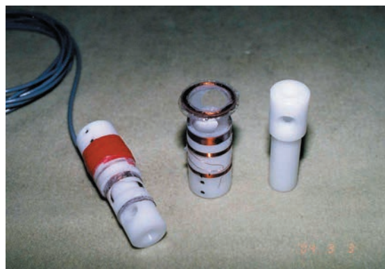
極低温コイルホルダー テフロン製でΦ 20 mm肉厚 0.2 mmの機械加工品
