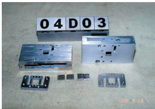
スリット枠 スリットを可動させるヒンジおよびスリットを固定する枠。精度が必要なためワイヤー放電加工で製作
