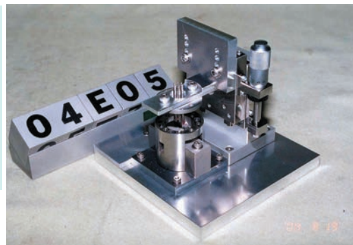
レーザー結晶ダイボンド治具 YAG 結晶をボンディングための直径 8mm の円周上をφ 2mm の導電接触ピン 4 本で固定する治具。
