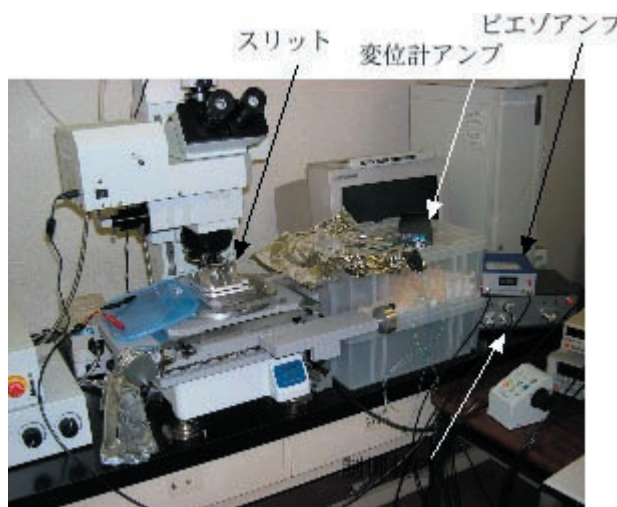
図4 制御装置取り付け
