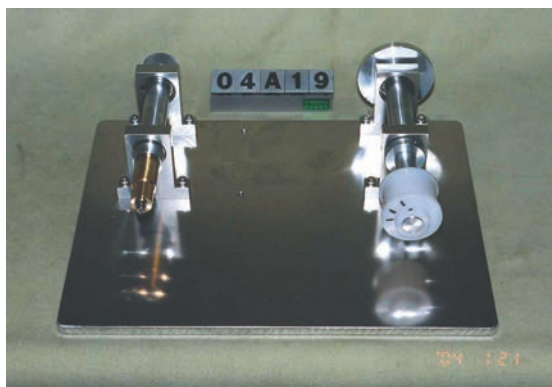
コイル巻機 テフロン製ボビン（肉厚 0.2 mm）に銅線を巻き コイルを作るための治具と機械
