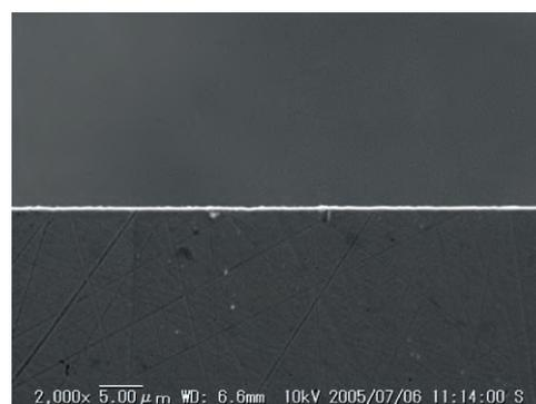
図 12 治具 2-no. 3 のスリット刃を中心から左に 3mm の位置を観察したエッジ像
