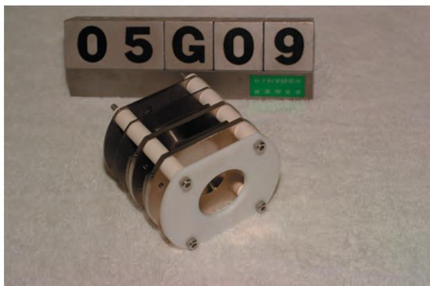
金属、セラミック、樹脂の高精度加工例。
