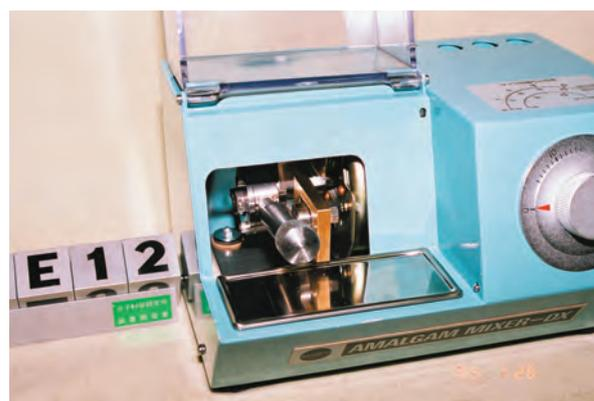
ステンレスカプセル内の粒状サンプルを粉碎する装置。
