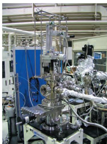
既存の装置に放射光エッチングのためのガス導入装置を増設。装置を分解せず現場で溶接および組立を行った。
