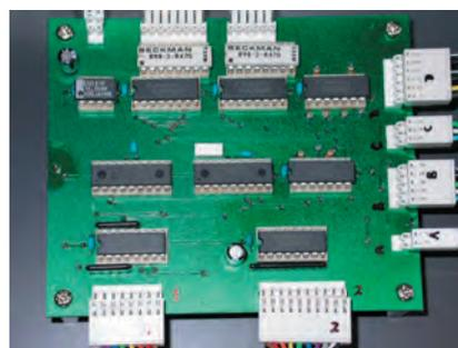
写真2 パルス発振器の回路基板
