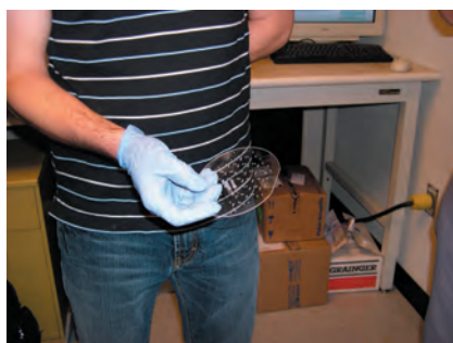
Microfluidics Lab の Tom Zangle 氏。 たいへん熱心に説明してくれた。手に 持っているのはマイクロ流路が作り込 まれた石英ガラス製ウェハ(写真右)。 フォトリソ設備を使って自作している。
