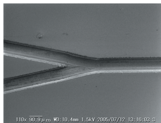
図 4 マイクロガラスチップ溝部 SEM 写真
