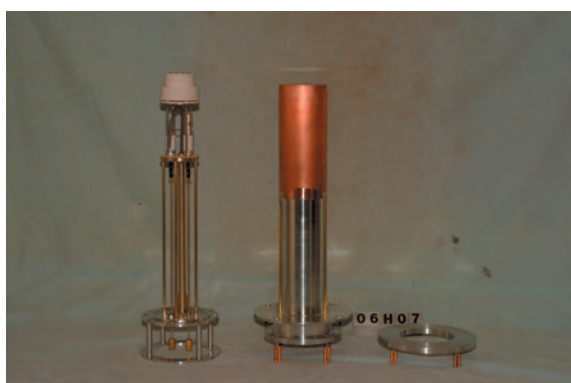
写真4：水冷ジャケットを外した状態
