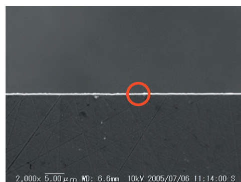
図 11 治具 2-no. 3 のスリット刃を中心から左に 3mm の位置を観察したエッジ像
