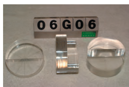
中学生向けのレーザー器機教材 光の屈折を見せるためのレンズ
