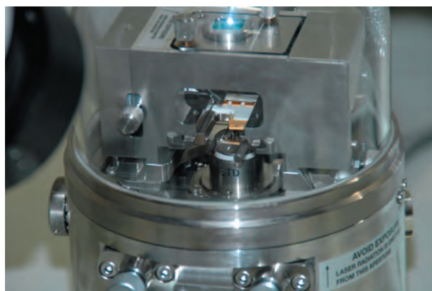
写真 2：計測中の STM セル
