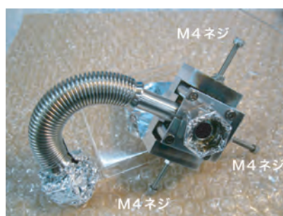
図6 治具に取り付けた継手
