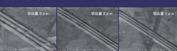
切込量1 μmの時エッジ部に欠けの無いグレーティング形状の加工が可能。
