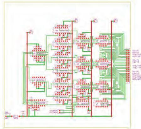
写真2 ゲート判定回路基板
