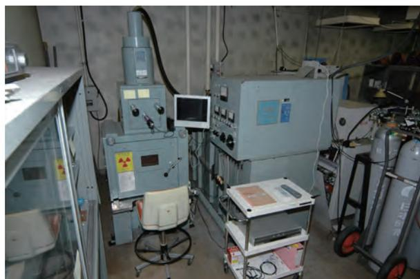
電子ビーム溶接機（NEC 製 EBW1.5 型）
