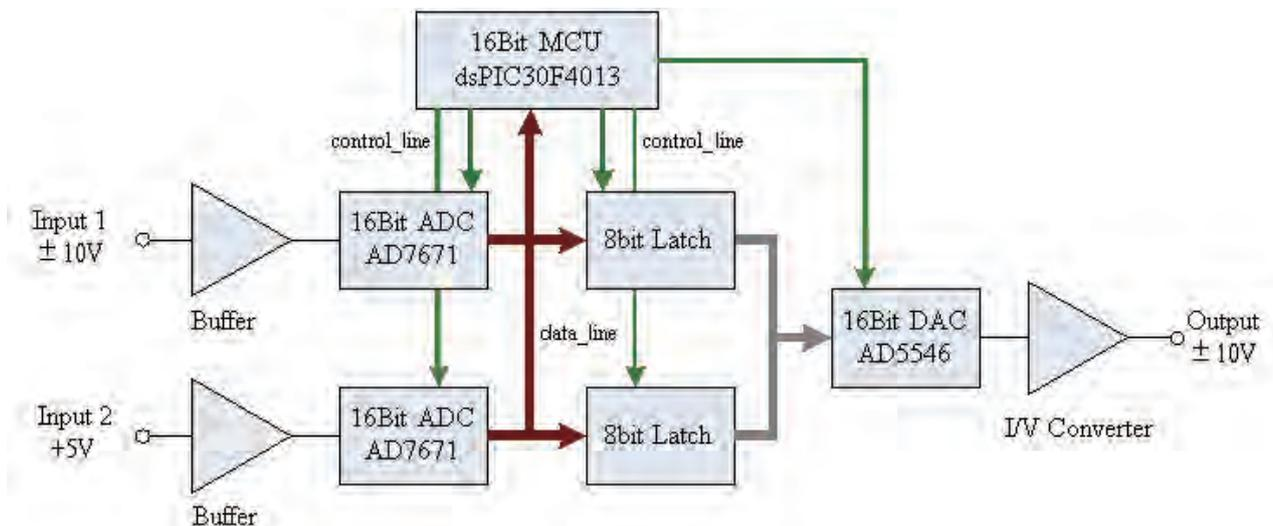
図 3 ビーム電流補正装置の構成
