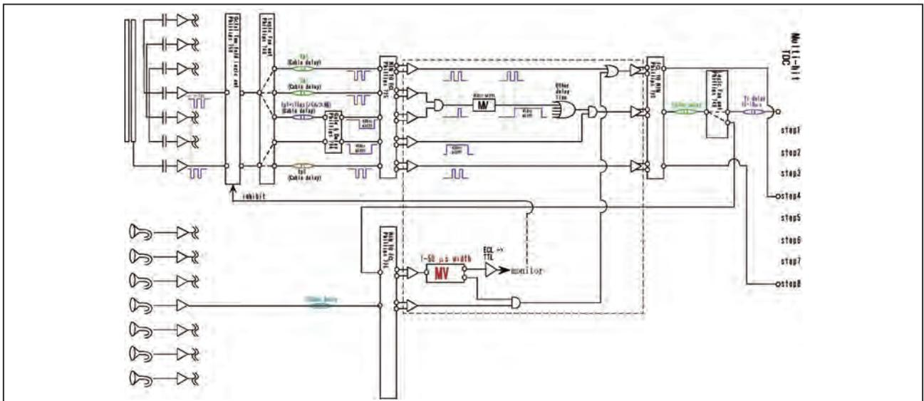
図2 同時計測回路ブロック図
