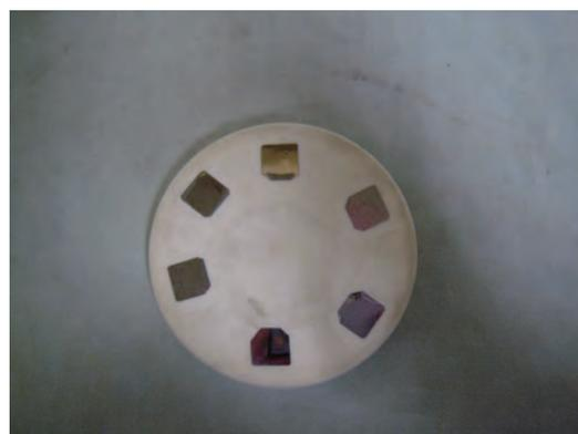
図3 試料固定台に接着したBD基板
