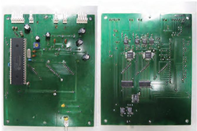
図 4 ビーム電流補正装置の回路基板
