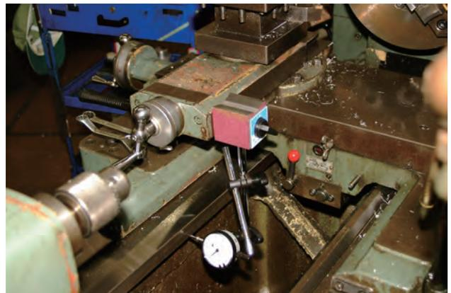
図4：ダイヤルゲージによるテーパー角度設定
