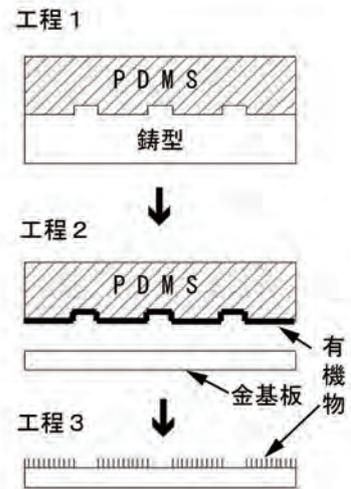
図 1 有機物のパターン作製過程
