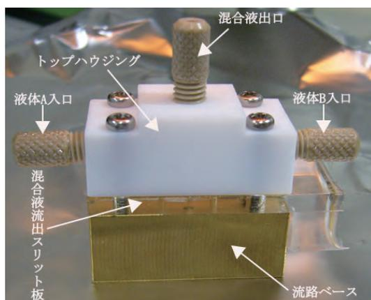
図1 マイクロミキサーの外観図
