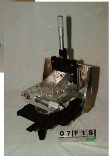
倒立顕微鏡用薄型 XY ステージ
