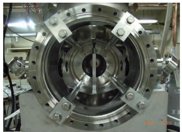
チャンバーに付随する装置類はそのままに ICF253 奥行き 325mm の位置に差動排気用の壁を溶接
