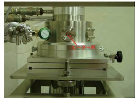
温度センサ: 金 - 鉄 - クロメル熱電対
