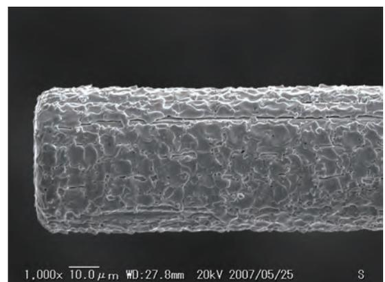
図 7 電極先端拡大図
