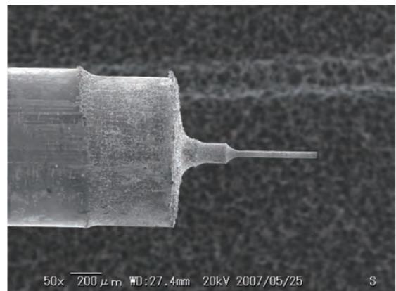
図 6 WEDG を用いて作った電極
