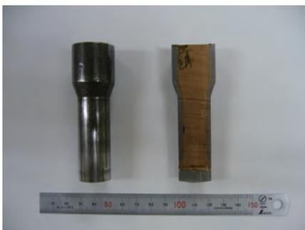
平成 18 年に行ったチタン銅 (Cu-Ti) 材に冷間加工と熱処理で材料強度を改良し、磁化率測定セルの製作 [1] で、強磁性の物質が混入している事が判明し精密な磁化率測定が困難であることが解った。原因はエアハンマーによる自由鍛造（塑性加工）で行った際に表面に付着した鉄粉を材料の中にたたき込み、また形状を変化させるので材料中に包み込まれた可能性が考えられる。この問題点の解決策として、（株）中部冷間より高圧プレスによる新たな塑性加工法が試みられた。12 月の時点で写真に示すように加工度（断面積減少率）約 48% で有効長さ 50mm の冷間加工が出来上がっている。加工後の硬度と熱処理および強磁性物質の有無について調べ、現在セルの製作を進めている。
