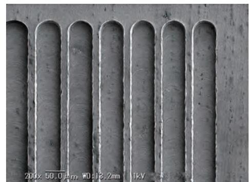
図 4 切削した溝の SEM 像
