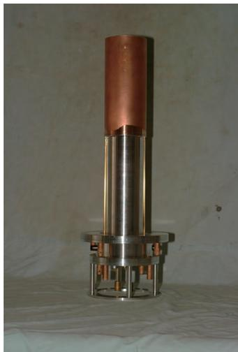
写真2 高温固体 NMR プローブ (2号機)
