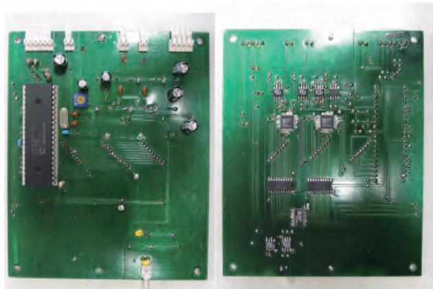
図 2.ビーム電流補正装置の回路基板
