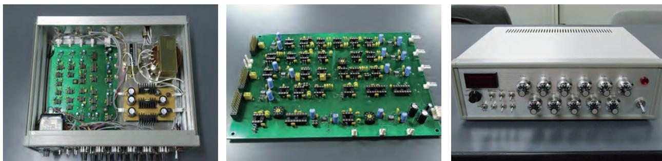
AFMをPID制御するフィードバック回路
