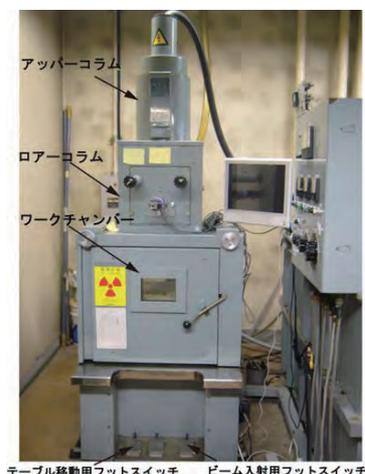
図 3. 電子ビーム溶接装置
