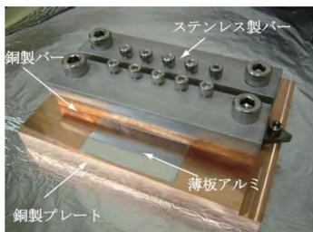
図 5. 突合せ溶接治具
