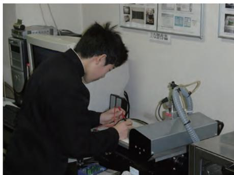
プリント基板加工機による基板製作
