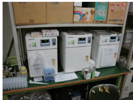
写真2：恒温槽を用いた結晶生成の様子
