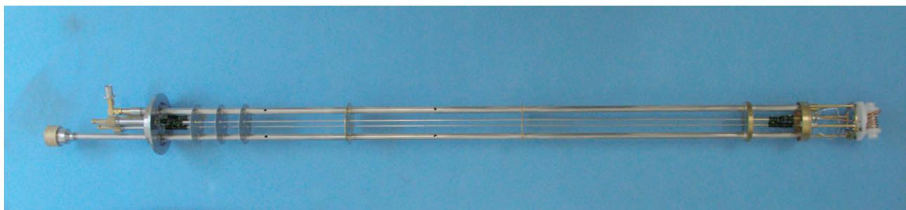
写真 1 固体 NMR プローブ (1 号機)(ラディエーションシールドを外した状態)
