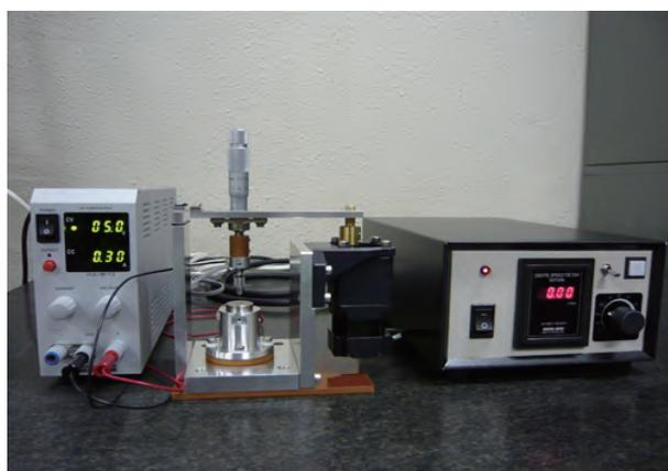
図2 製作したCNT探針作製装置
