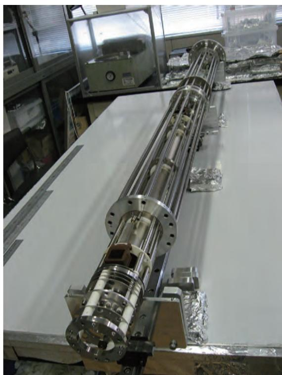
写真 気体核磁気共鳴分光装置用磁気共鳴セル
