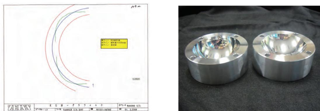
図3. 鏡面検査の結果
