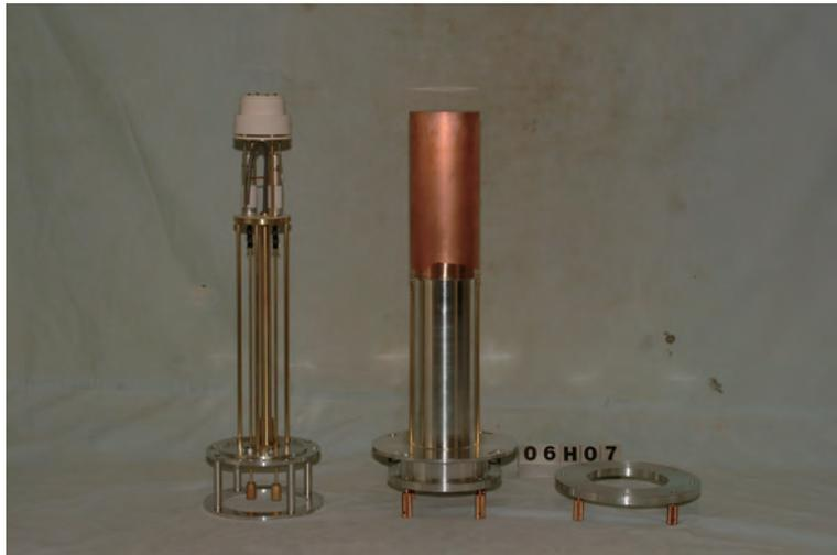
写真3 水冷ジャケットを外した状態
