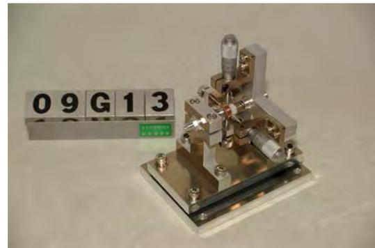
Q スイッチレーザーのミラーを調整固定する専用治具
