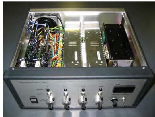
図 5. PID 温度制御回路の外観
