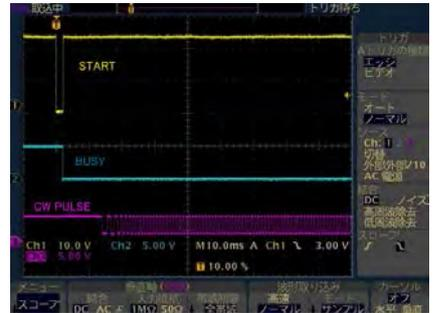
データメモリ型ステップモータ・コントローラとPICマイコンを組み合わせたステージの駆動制御
