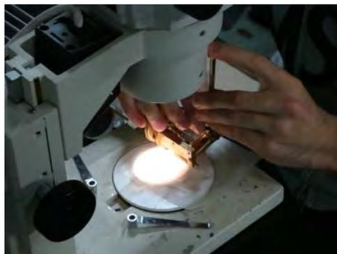
写真 1: プローブへの試料装填
