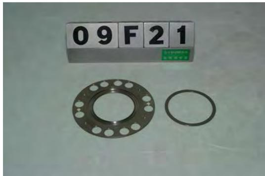
透過率 95% の銅メッシュを 1mm と 0.5mm のチタンプレートではさみこみスポット溶接
