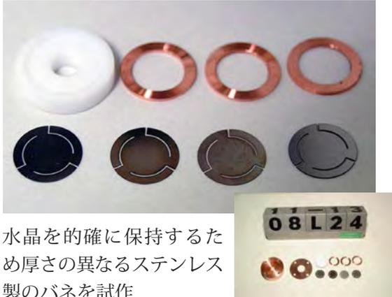
水晶を的確に保持するため厚さの異なるステンレス製のバネを試作
