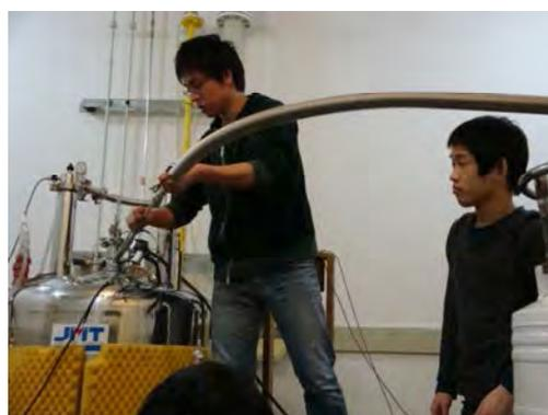
写真 4: トランスファーチューブの挿入
