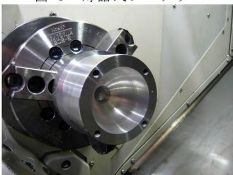
図5 仕上げ切削後の分割回転楕円体面鏡
