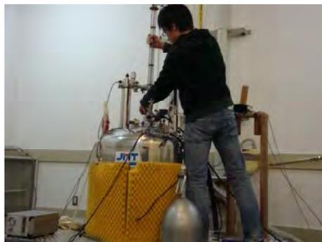
写真 2: プローブのマグネットへの挿入
