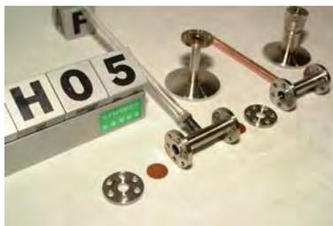
パイレックスガラス、コバール金属、ステンレス金属を接合したセル
