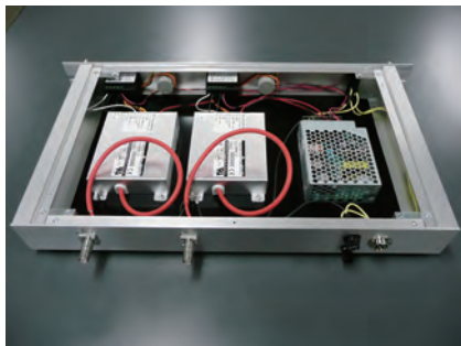
2 チャンネル 3KV 高圧電源 出力電圧: 0\sim 3\text{KV} , 出力電流: 0\sim 1\text{mA}
