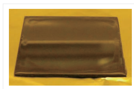
図3 スピコートでレジストを塗布した基板の写真。基板の端の部分でレジストが盛り上がって付いていることが分かる(エッジビード)。
