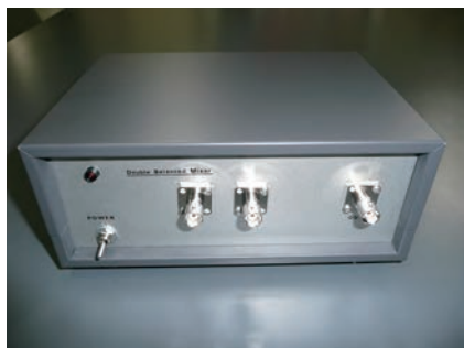
AD633 (Analog Devices) アナログ乗算器を使用した DBM 回路 2つの入力信号 f_1, f_2 の和周波と差周波 ( f_1 \pm f_2 ) 信号を出力
