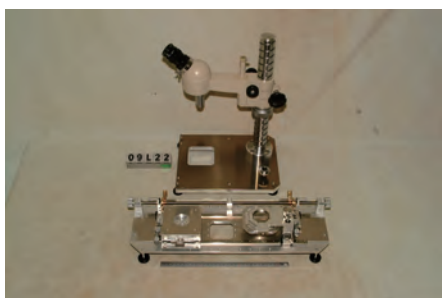
（図 1. 分割した顕微鏡とステージ）
