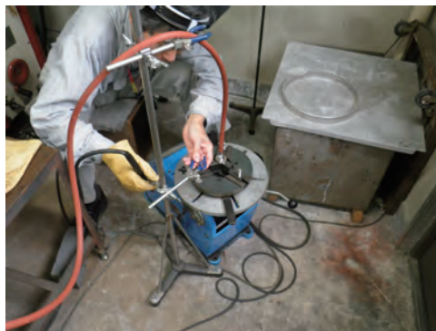
図 1 真空溶接の様子
