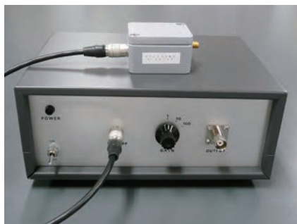
LOG101 (Texas Instruments) 対数アンプを使用した STM 用信号処理回路 IV 変換部ゲイン: 0.1 \text{ [V/nA]} 、非反転アンプゲイン: 0\text{dB}, 20\text{dB}, 40\text{dB} LOG アンプ: V_{\text{out}} = \text{LOG} ((V_{\text{in}} \text{ [V]} / 10\text{K} [\Omega]) / 1 \text{ [uA]})
