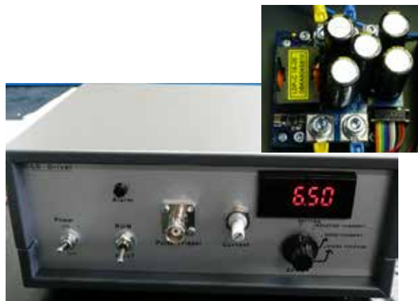
LDP-C1805(PicoLAS) を用いた 高出力 LD 駆動回路
