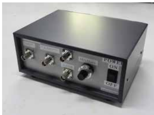
TTL トリガ信号を 1/2 分周し 振幅を 0 ~ ± TTL レベルで同時出力する回路
