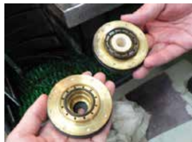
図 4 ノズルの交換(テーパ加工)
