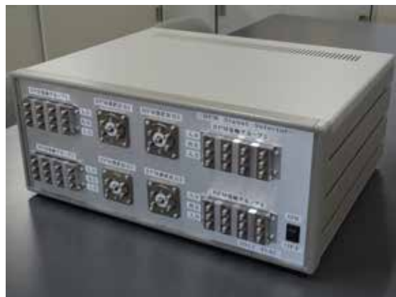
UVSOR のストレージリングを周回する電子ビームの位置情報信号 (BPM)8 組 × 4 から任意の 1 組 × 4 を選択出力する回路
