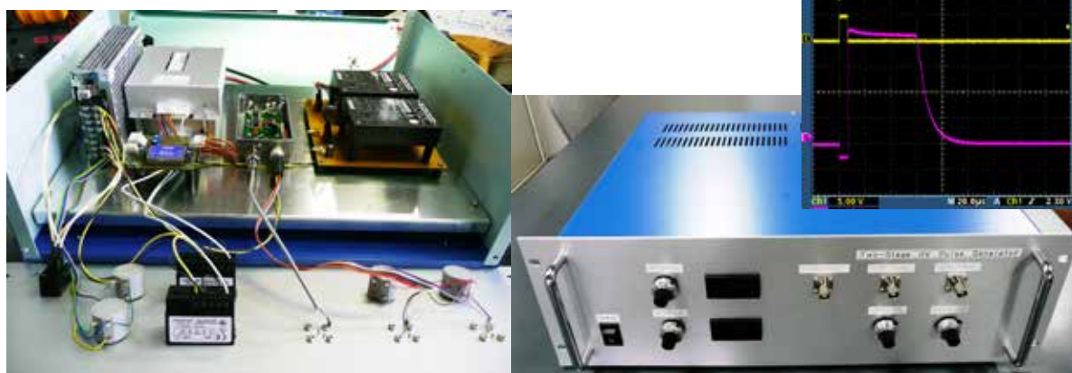
高電圧スイッチ・モジュール (Behlke) を使用した負電圧・正電圧パルス連続出力回路
