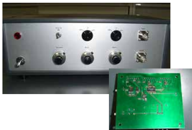
立ち上がり数 nsec、振幅 10mV ~ 1V のトリガー入力から TTL レベル出力信号を発生する回路
