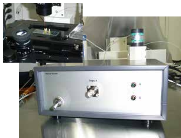
マイクロ流路に流す溶液を切り替えるためのソレノイド式スライダバルブの駆動回路
