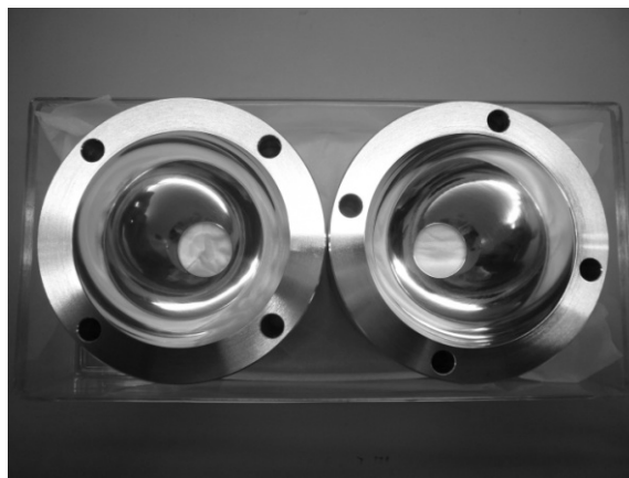
図8 製作した分割回転楕円面鏡
