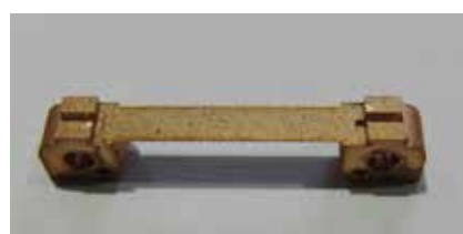
図 4. Be-Cu 合金で作製した試料治具（歪ゲージ治具）
