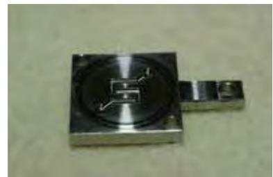
燃料極側電極。水素が流れるための溝が加工されている。
