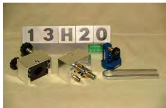
超高精度微調スクリュー (1/4" -254TPI) の組込みでさらに厳密なミラー調整を可能にした。
