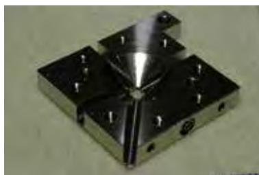
空気極側電極。光電子分光測定用に入射 X 線の通る溝と検出器のアプローチをモニターするための溝を加工した。
