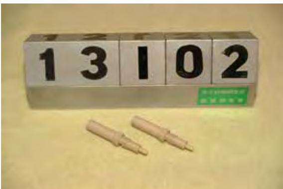
流路接続用バルブ。当初絶縁を考慮してポリイミド樹脂で製作したが破損をしたため、延性のあるポリエーテルエーテル酮 (PEEK) に変更した。
