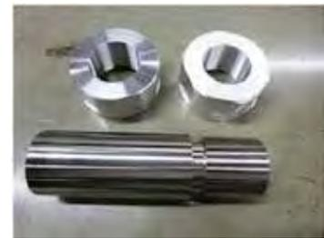
図 5 CNC 旋盤加工品
