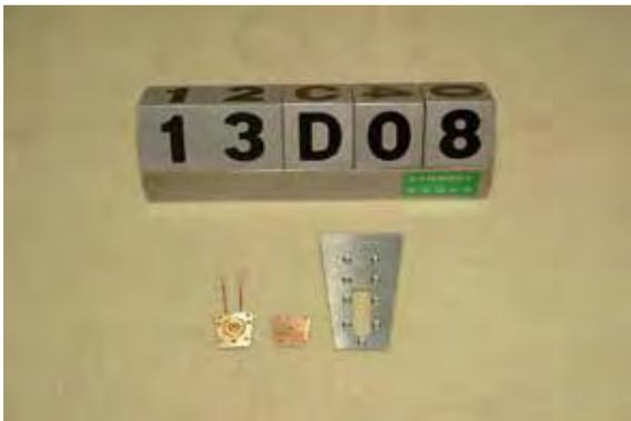
in-situ 液体フローセル試作機。非常に狭い空間に液体セルを設置するため厚みが  $\leq 2\text{mm}$  になっている。
