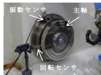
図5 フィールドバランスによるアンバランス振動ベクトル調整
