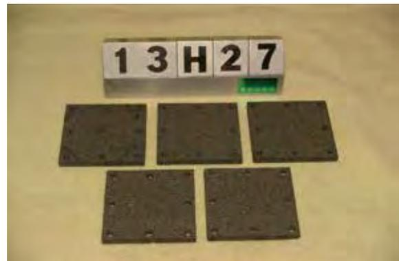
次世代多孔質カーボン素材「CFOAM」の穴あけ加工。通常工具による難加工材料への穴あけに挑戦した。
