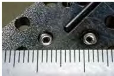
1/16" ステンレスパイプの溶接による水素ガスの流入口と排出口。
