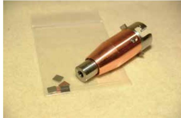
次世代 UVSOR のための電子銃で、背面からレーザー照射することができる、超伝導電子銃用フォトカソードプラグ。
