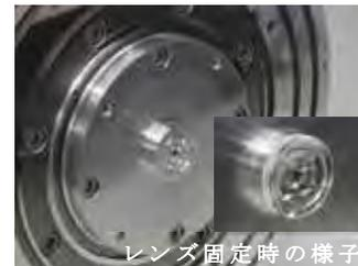
図4 真空チャック方式の治具
