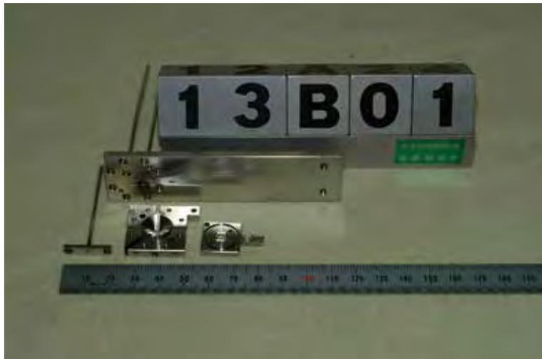
動作中の電極触媒を光電子分光により in-situ 測定するための燃料電池型セル。触媒のついた高分子膜を両電極で挟み、各極に水素および酸素を流すことで燃料電池として動作する。
