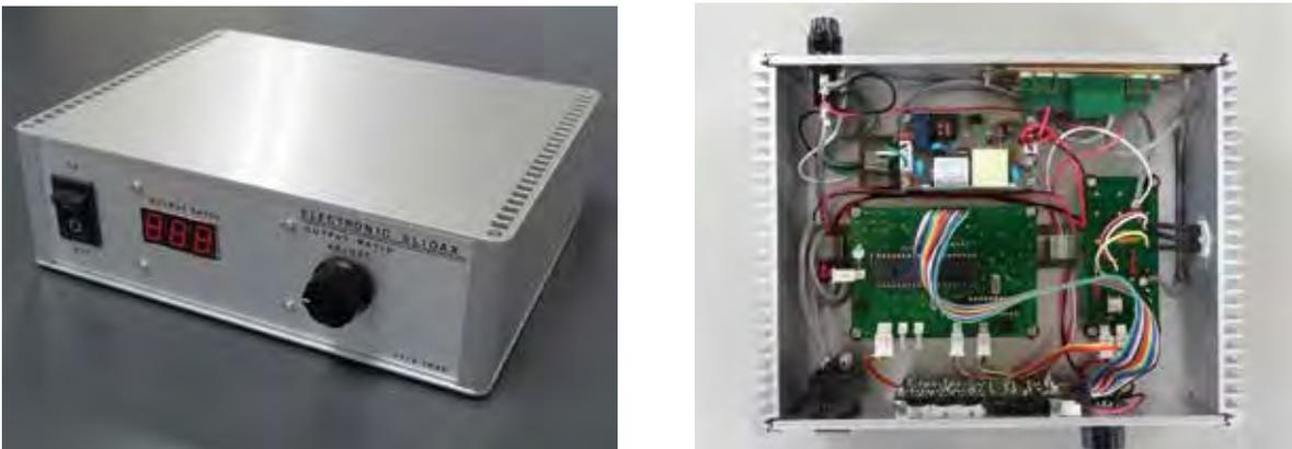
AVR マイコンによる位相制御により、従来のスライダックより重量や容積を大幅に削減しつつ、
