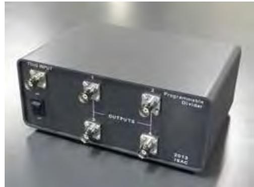
レーザーからの 1kHz 出力を基に、最大 8 チャンネルの TTL レベル論理回路出力を生成する。
