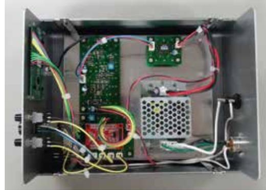
周波数範囲 5Hz ~ 2kHz、分解能 1Hz の TTL レベル出力パルスジェネレータ
