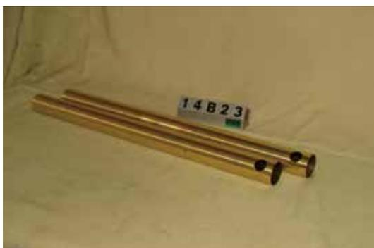
図1：スリーブ (540 ×  $\phi$  39.0 × 0.5t)
