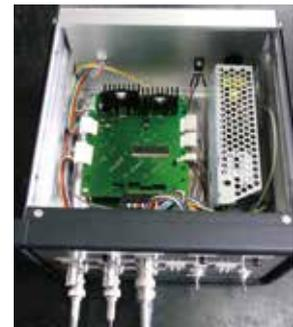
レーザー光のシャッターを分周 (n)、ショット数 (m)、待ち時間 (w) の設定に応じて開閉制御
