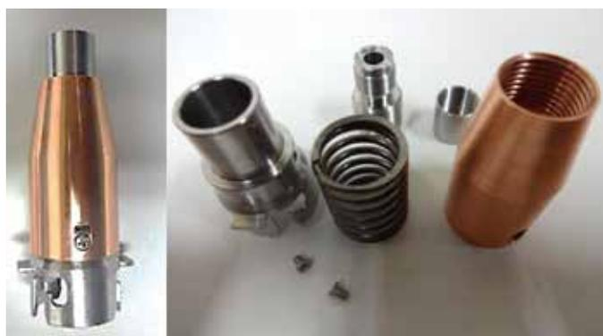
図4、超伝導 RF 空洞用フォトカソードプラグの試作品
