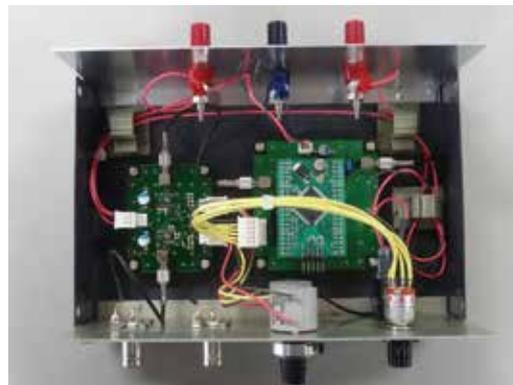
フェムト秒レーザーの 40MHz 発振出力を検出・増幅・分周し、TTL レベル信号で出力
