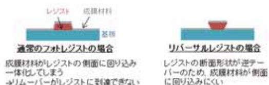
図 3 ポジ型レジストとリバーサルレジストの断面形状の違いとリフトオフへの影響
