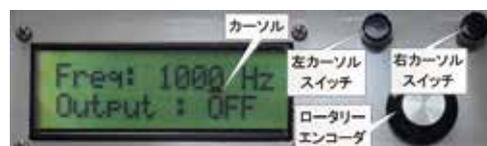
図 4 : スwitch 類と液晶ディスプレイ
