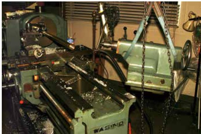
図8：作業風景、真鍮パイプの着脱時には芯押台を外す必要がある
