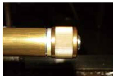
図5：サポートリングの挿入
