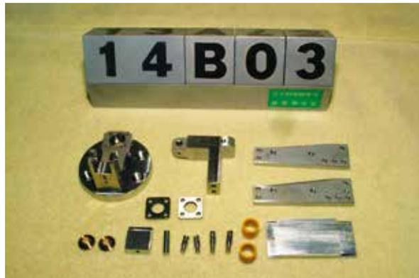
UVSOR で使用する真空内で試料を劈開するための構成部品
