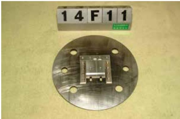
各種サイズのペレット状サンプルを破損させる事無く容易に保持するためのステージ
