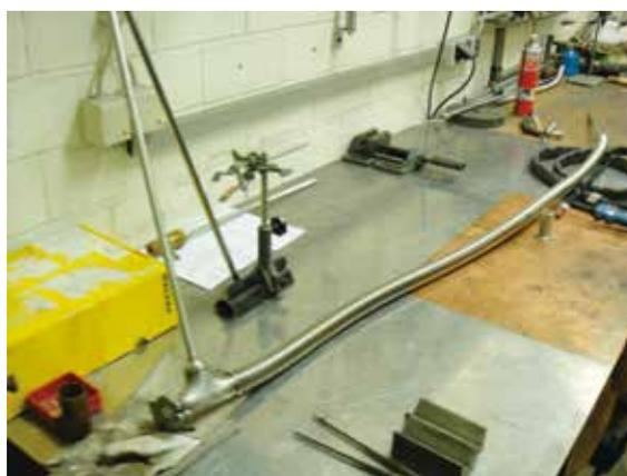
写真 7：トランスファーチューブの製作
