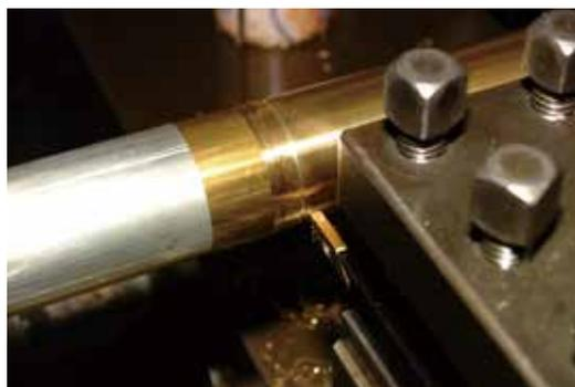
図7：全長540mmで突っ切り仕上げとする
