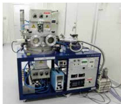
図 1 小型 2 源 RF スパッタ装置 （クライオバック製）
