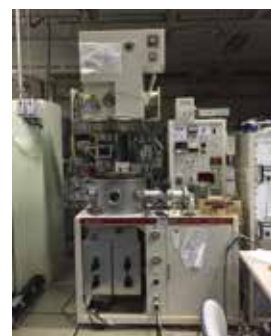
図 1 使用した RF スパッタ装置 SPUTTERING SYSTEM HSR-552（島津製作所）
