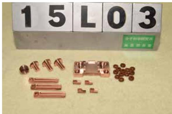
光電子分光実験に使用する冷却型サンプルホルダー。
