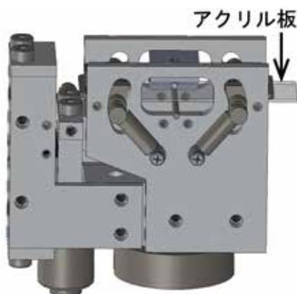
図1 有機単結晶曲げ装置の3D図
