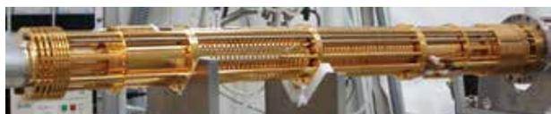
図 8 : 速度分散補償器を組み込んだ改良型 NMR セル
