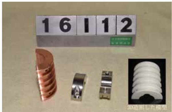
サンプルやサンプルホルダーなどに帯電している電位を除去するためのものである。この金具が取り付けられるスペースには多くの制限があることや、上手く機能する形状を追求する必要があり、3D プリンターで試作を行いながら最終形状を決定した。
