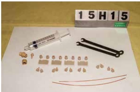
液体試料に外部電場を印加した状態で吸収スペクトルや小角 X 線散乱の測定を行うためのガラス製フロー型電場セル。測定部である溶液槽、通液用の穴と PEEK 製コネクタ、外部電場を印加するための透明導電膜をカバーガラス上に製作した。
