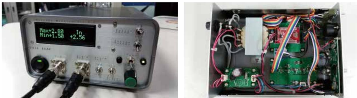
図 2：完成した電圧モニター回路の写真。左が外観、右が内部の基板及び配線。
