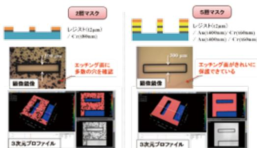
図 6：2 層マスクと 5 層マスクによるエッチング面への影響
