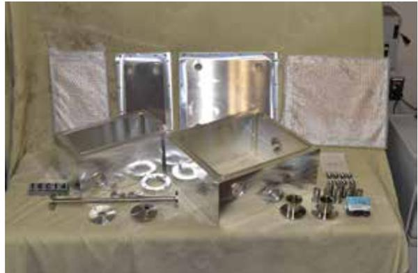
レーザー実験において、空気中の水蒸気の影響をさけるためにアルミ材料を削り出して製作した真空容器。
