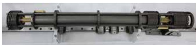
図 10 : グラファイトコートした NMR セルの写真
