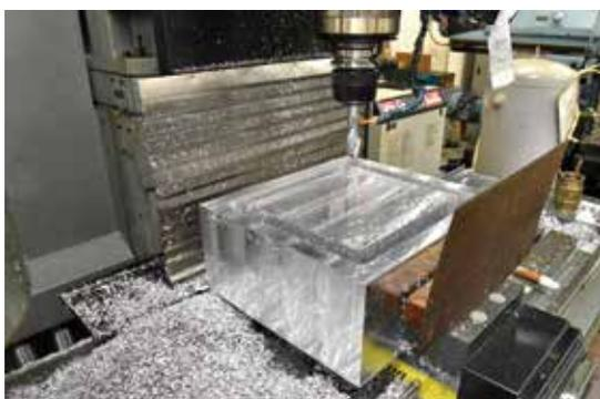
図 6 : アルミ材料の削り出し
