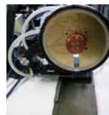
2014 年製作の回転セル制御装置と連動した自動計測のためのビームシャッター駆動装置
