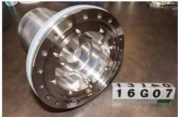
真空中で分子線用ノズルを摺動可能な機構をICF203フランジに設計製作した。
