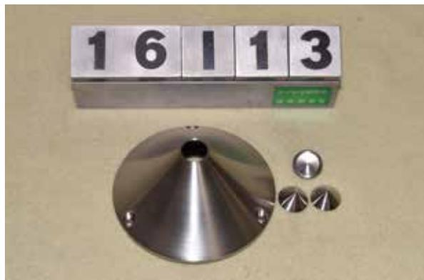
直径  $\phi$  79mm、高さ 44mm のコーン形状
