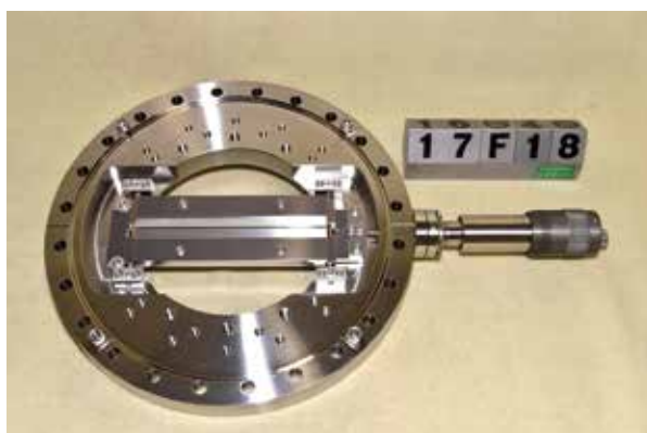
図2：スリット機構全景
