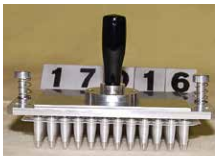
図 4：プレートにマグネットデバイスを装着したときの様子
