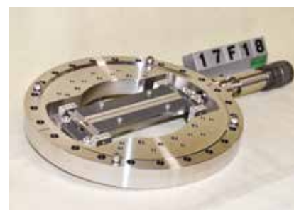
図 2：超高真空用スリット機構
