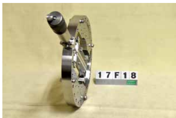
図3：スリット機構全景
