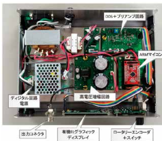
図1：開発したバイモルポンプ駆動用高電圧アンプの内部全体像
