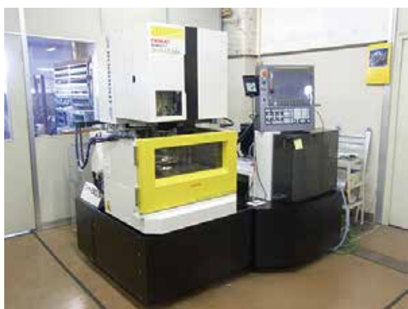
図 1：更新したワイヤ放電加工機 (ファナック株式会社製 \alpha -C400iB)
