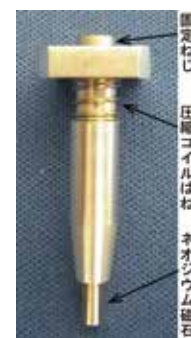
図 5：圧縮コイルばねを装着した簡易モデル
