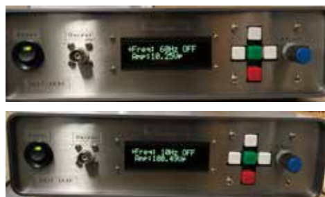
図 2: 送液ポンプ制御用の AC インバータ電源 (上: 60 Hz, 10 V 出力, 下: 10 Hz, 100 V 出力)
