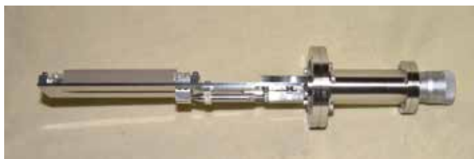
図1：ICF70用スリット機構
