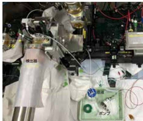
図 1: 電気化学 XAFS 計測のセットアップ (KEK-PF BL9A にて)
