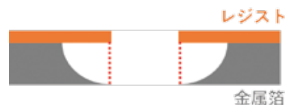
図1：等方性エッチングの断面形状 赤い破線のように垂直に加工できない
