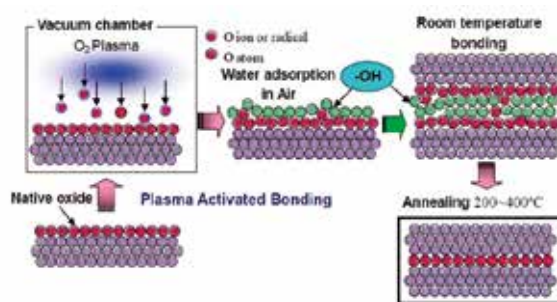
図1：低温接合の概略図
