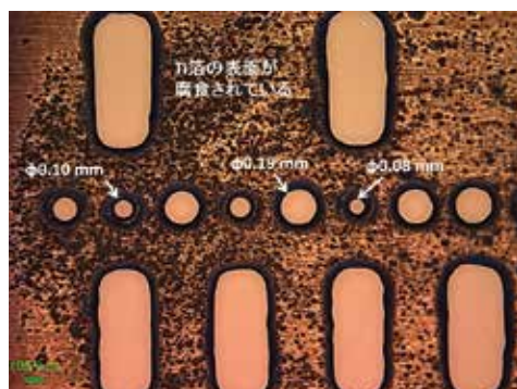
図6：Ti箔の顕微鏡画像 (Ti箔 t0.05\text{mm} を両面からエッチング)
