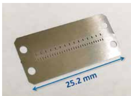
図3：フォトエッチングで製作した微細形状を有する薄板
