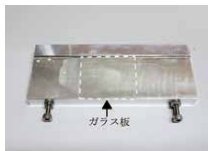
図2：ワックスでガラス板を固定したアルミ製治具
