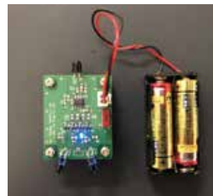
図 1: 製作した「電子ホタル」。基板の上辺の突起が光センサー、下側の 2 個の突起が赤外 LED。
