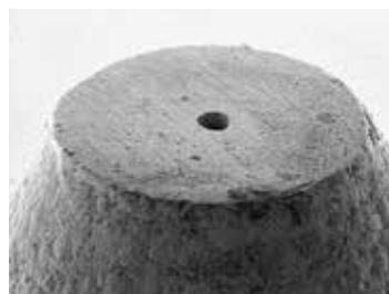
図6：FIBで加工した穴(50um)
