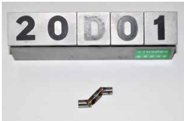
市販品がないため、溶接技術を使用し小型形状のユニバーサルジョイントの製作をおこなった。部品が小さいため、高度な溶接技術が必要とする。
