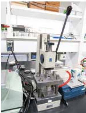
モリブデン電極は消耗品で、以前は手作業で切り抜いていたが、整った形状品を製作することが難しかった。市販のプレス機を改造して研究室が使用する形状の型を抜けるようにした。
