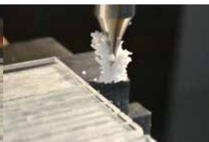
図 13：刃先に付着した PMMA 切粉
