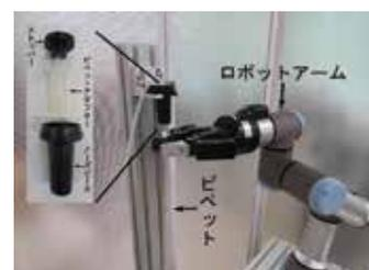
図5：ピペット挿入時の様子
