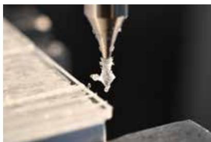
図 11：刃先に溶着した PS 切粉
