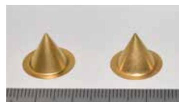
図8 完成した分光用ノズル
