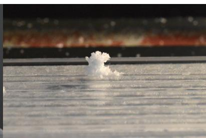
図 12：樹氷のような PMMA 切粉
