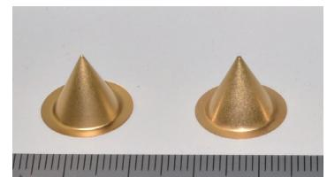
図8 完成した分光用ノズル
