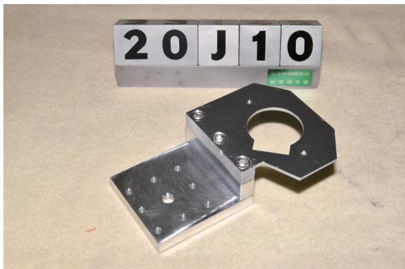
AFMに設置して使用するアルミ製板。3Dプリンタで試作し形状を確認後に金属加工をおこなった。
