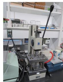
図3：モリブデン電極を成型する専用プレス機
