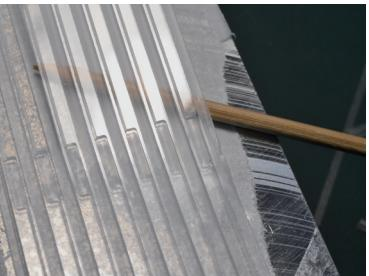
図 9：竹串による剥離
