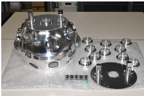
極端紫外光研究施設で使用する検出器の外形状は外注加工しアレイを固定する部品製作をおこなった。
