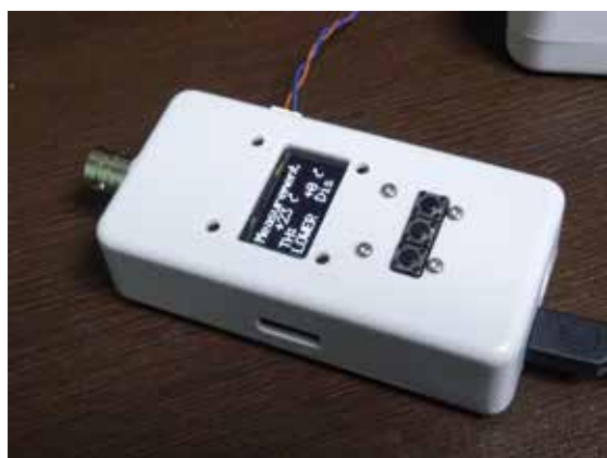
図4：開発した広範囲温度計測ユニット [1]
