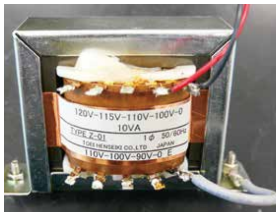
図1：融解した電源トランス
