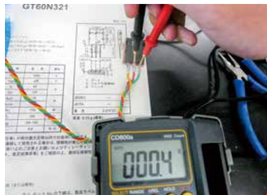
図3：機器内蔵の IGBT のコレクタ - エミッタ間が短絡している様子
