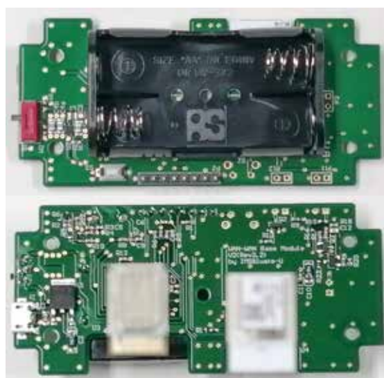
図3：改訂した防災システムの基本モジュール 上側写真の左隅が、新開発のDC-DC電源回路
