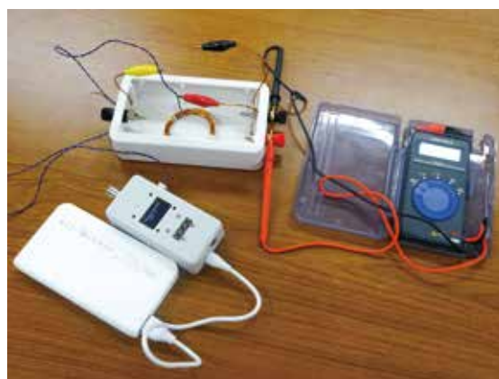
図5：開発した抵抗温度依存性測定キット [2]
