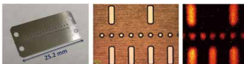
図 3：電子点光源から立体角で上から 4、1、2 度の間隔で穴が配置されている金属メッシュ (左)。金属メッシュの顕微鏡像 (中央)。ディフレクター機能を使用して観測した金属メッシュを透過してきた光電子像 (右)。
