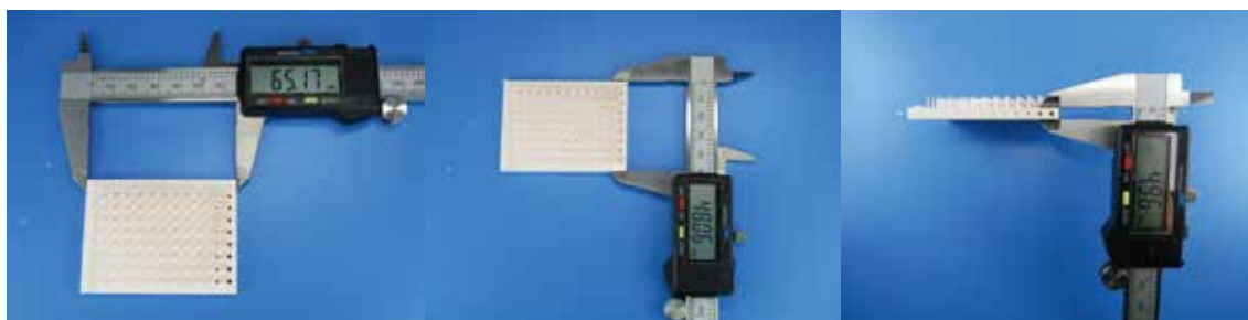
図9：造形精度の確認
