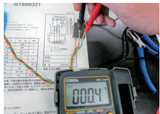
図3：機器内蔵の IGBT のコレクタ - エミッタ間が短絡している様子
