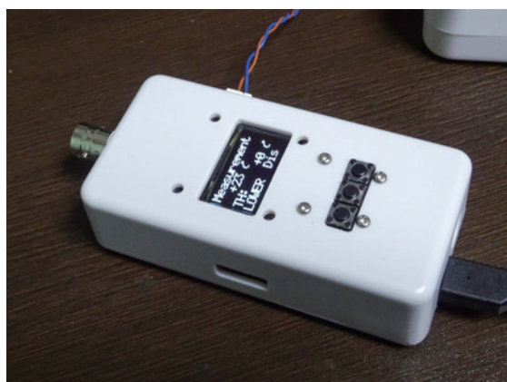
図4：開発した広範囲温度計測ユニット [1]
