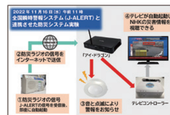
図1：今回のJアラート試験放送を用いた実証試験のイメージ [1]
