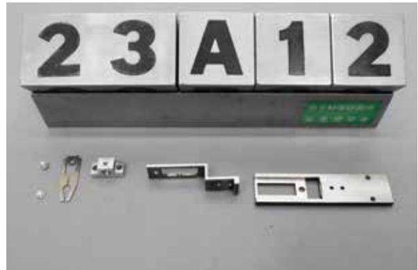
左から 2番目の糸切りばさみの形状をしている薄板の部品、左から4番目の階段状の部品はワイヤー放電加工機を用いて加工した。
