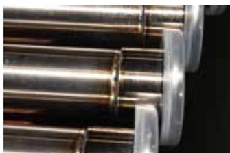
図4：ヘリウム回収管の溶接部
