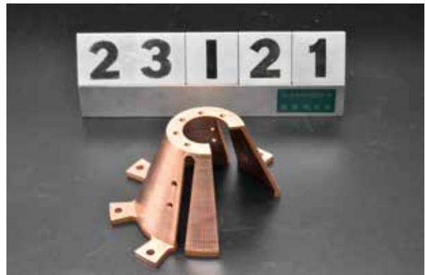
電磁波の反射率と冷却効率を考慮し銅を用いて作製をおこなった。内外のテーパ形状はNC旋盤、放射状のフランジ部分はワイヤー放電加工機を用いて加工した。
