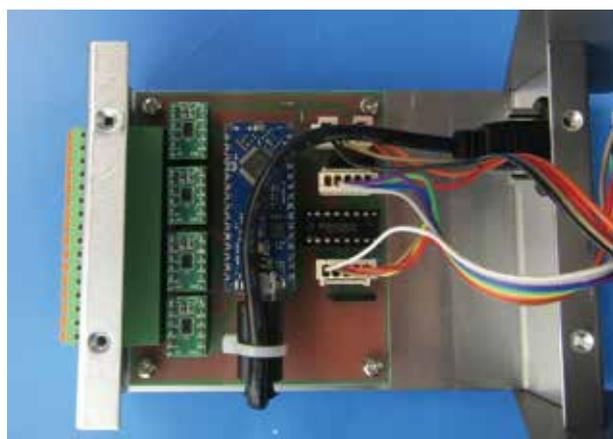
図 7: コントローラ内部構造
