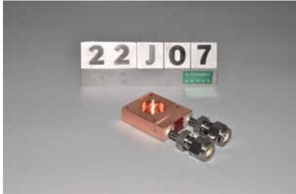
銅部品を加工後、パイプ継手部品を銀ろうで接合した。銀ろう後に付着する酸化被膜は、紙やすりなどを用いて除去したので、写真のような光沢のある仕上がりになった。
