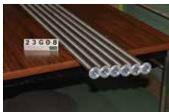
図3：完成したヘリウム回収管
