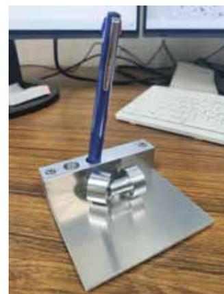
図1：旋盤研修で製作したM12ねじと、フライス研修で製作したペン立て付メモスタンド
