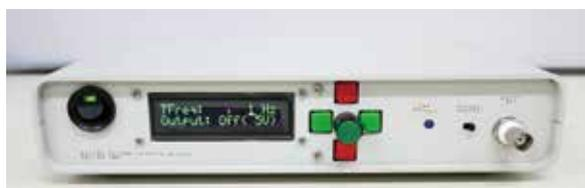
図 1: 製作した UV-LED 駆動用パルスジェネレータ
