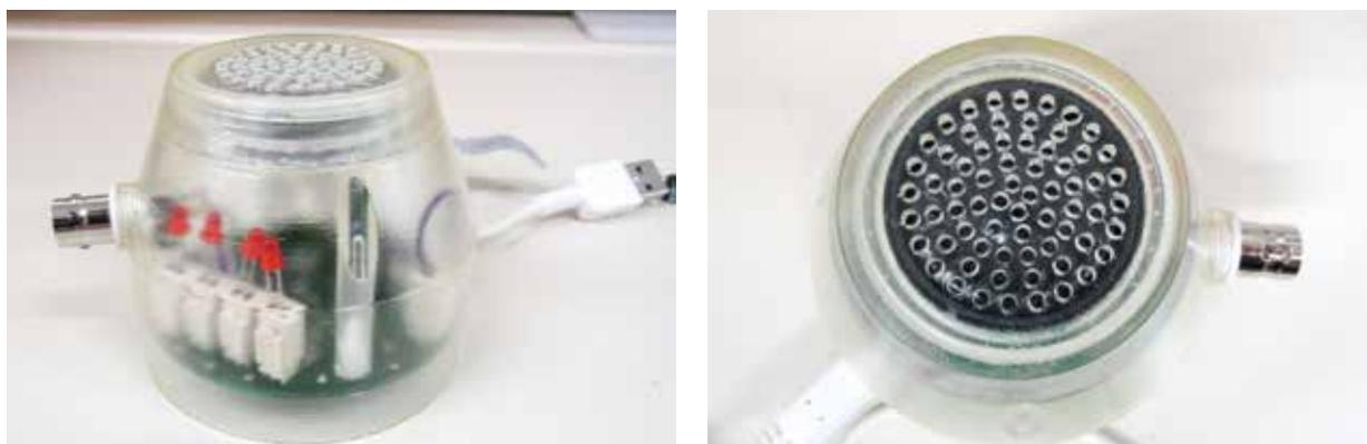
回路工作室が製作した警報ランプ用のケース。警報時に赤色点灯するため透明色で作成。警報音を発するスピーカーも内蔵出来る。
