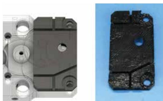
図 4：3D プリンターで作成した配線カバー
