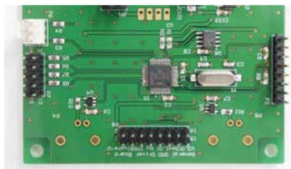
図 2: 内蔵したパルスジェネレータ基板
