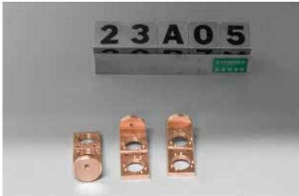
熱伝導率が高い銅を使用して作製した。小型形状のため、小径穴は工具の折損に注意を払い加工をおこなった。
