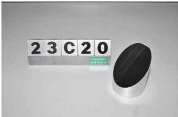
最初に加工面の表面粗さと加工条件を検討し、その後、5軸加工機を使用し、放物面形状の加工をおこなった。曲率が異なる5種類の形状を加工した。写真はその中の1種類である。
