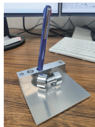
図1：旋盤研修で製作したM12ねじと、フライス研修で製作したペン立て付メモスタンド
