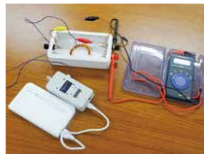
図1：演習で使用した抵抗温度依存性測定キット
