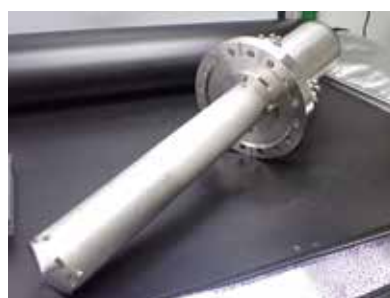
図8：完成した真空容器
