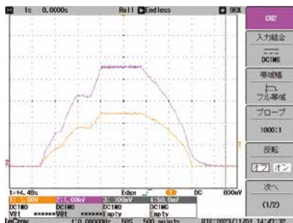
図 3: 制御入力電圧 (橙) に対する出力電圧 (赤) 制御入力 2V/div、出力 1kV/div、横軸 1s/div
