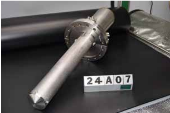
24A07 冷却ガス導入用ユニット
