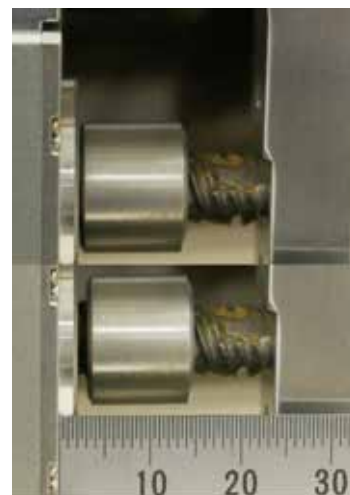
図 3 : アクチュエーターの根本付近 上 : 往復移動前、下 : 往復移動後
