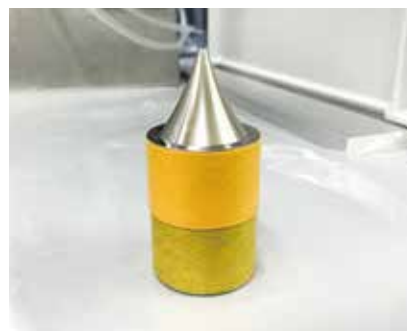
図 5 : めっき直後のスキマーの様子
