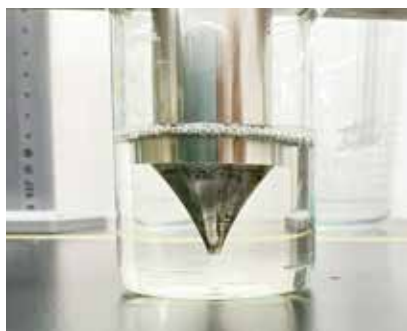
図 4 : 汚れた母型を希硝酸に漬けている様子
