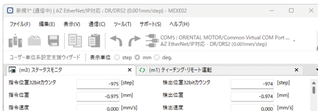
図 2 : 付属ソフトウェア MEXE02 でのステータス表示 (原点 =0 から開始、100kHz 往復終了時点)
