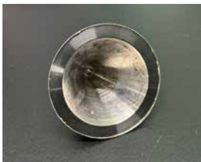
図 3 : ピットや汚れの発生しているスキマーの様子
