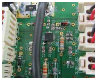
図 2 : 実装した Gate Driver IC ( 中央の黒い IC)
