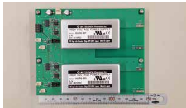
図3：OMLプロジェクトで開発したオンボード型高電圧電源回路のプリント基板
